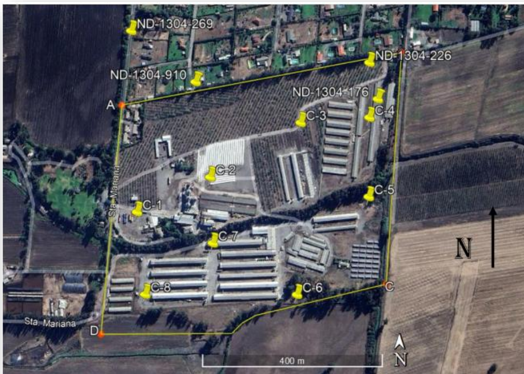
Figura N° 18. Ubicación de calicatas de exploración
