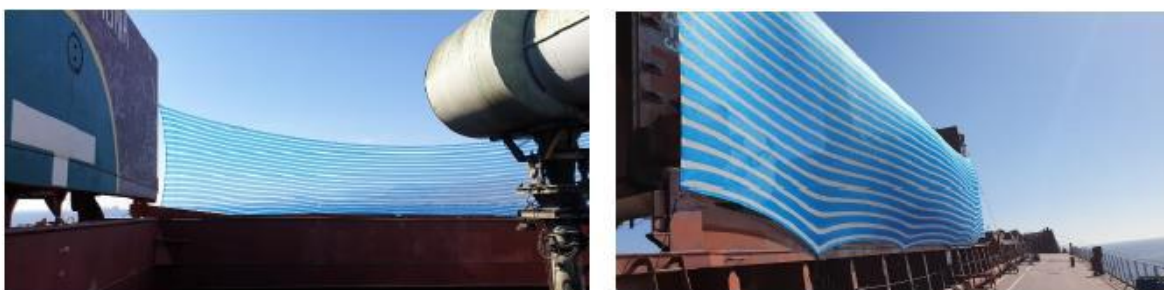
Figura N° 14: Malla raschel instalada en área de bodega
